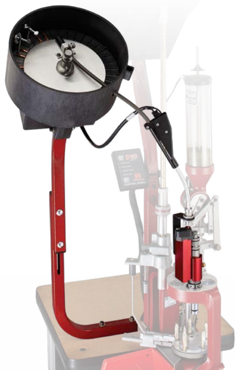
Podavač střel do pušky aktivovaný nábojnici je také kompatibilní s modelem Dillon XL 650. Více na hornady.com
