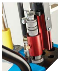
Podavač střel do pušky aktivovaný nábojnici je také kompatibilní s modelem Dillon XL 650. Více na hornady.com
